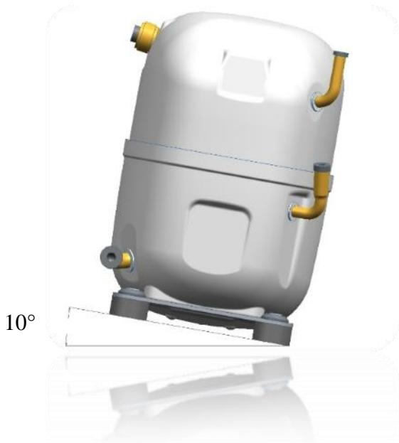
Przed rozpoczęciem lutowania przewodu wyrównawczego oleju sprężarek AJP należy przechylić sprężarkę pod kątem co najmniej 10°, jak pokazano na ilustracji.
