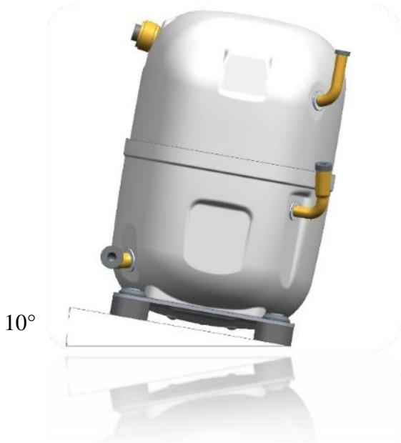
Prima di saldare il tubo di equalizzazione dell'olio sui compressori AJP, inclinare il compressore di almeno 10°, come mostrato.
