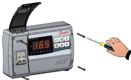
Rys. 2 Odkręcić 4 wkręty mocujące znajdujące się w przedniej części skrzynki.
