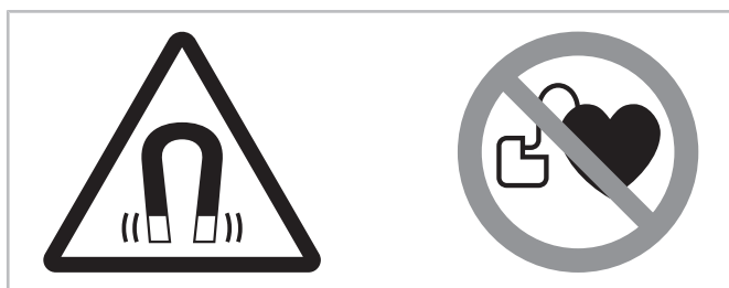
Fig. 8: Panneaux d'avertissement et d'interdiction sur un compresseur avec moteur à aimant permanent
